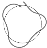
Figura 27. Una onda estacionaria ordinaria comparada con una onda estacionaria circular
